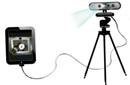
Figure 17 Caméra Matterport contrôlée par iPad (Source : www.fastcompany.com )
