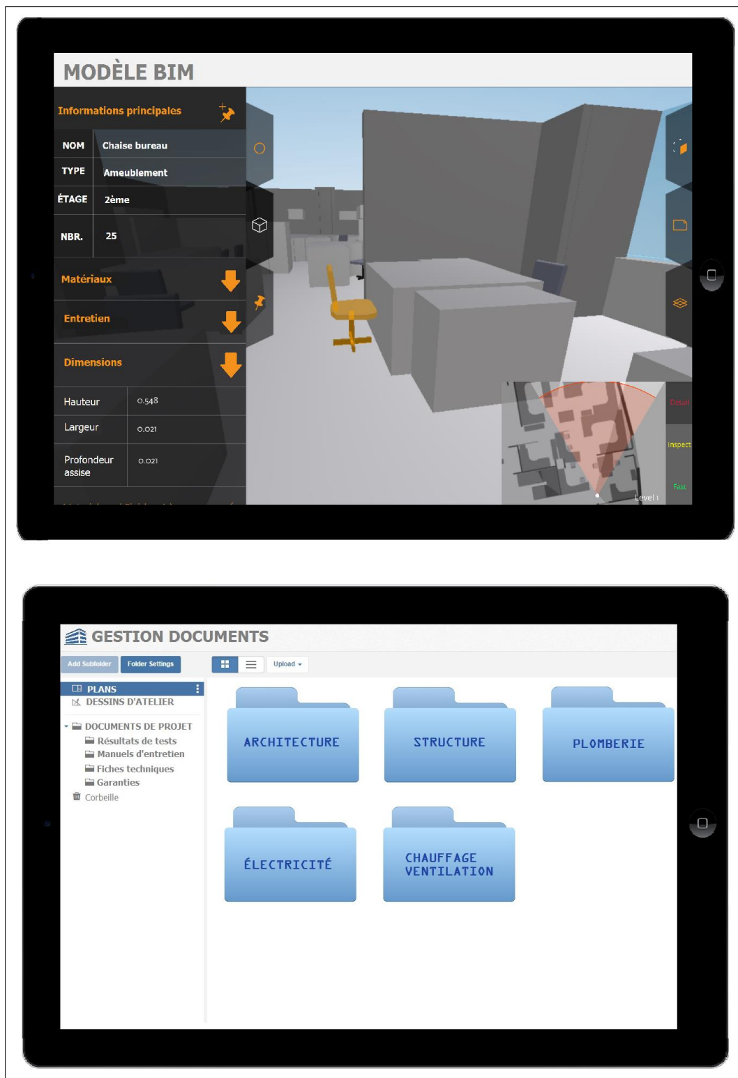
Figure 4.3 Centralisation des données du bâtiment avec BIM (en haut) et sans BIM (en bas)
