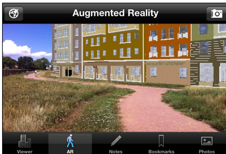
Figure 5.1 Utilisation de la RA pour visualiser la conception du futur projet en contexte réel Tirée de Errin (2011)
