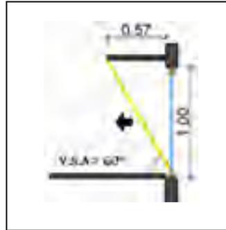
Figure 3.18 Profondeur requise d'un auvent d'une façade sud
